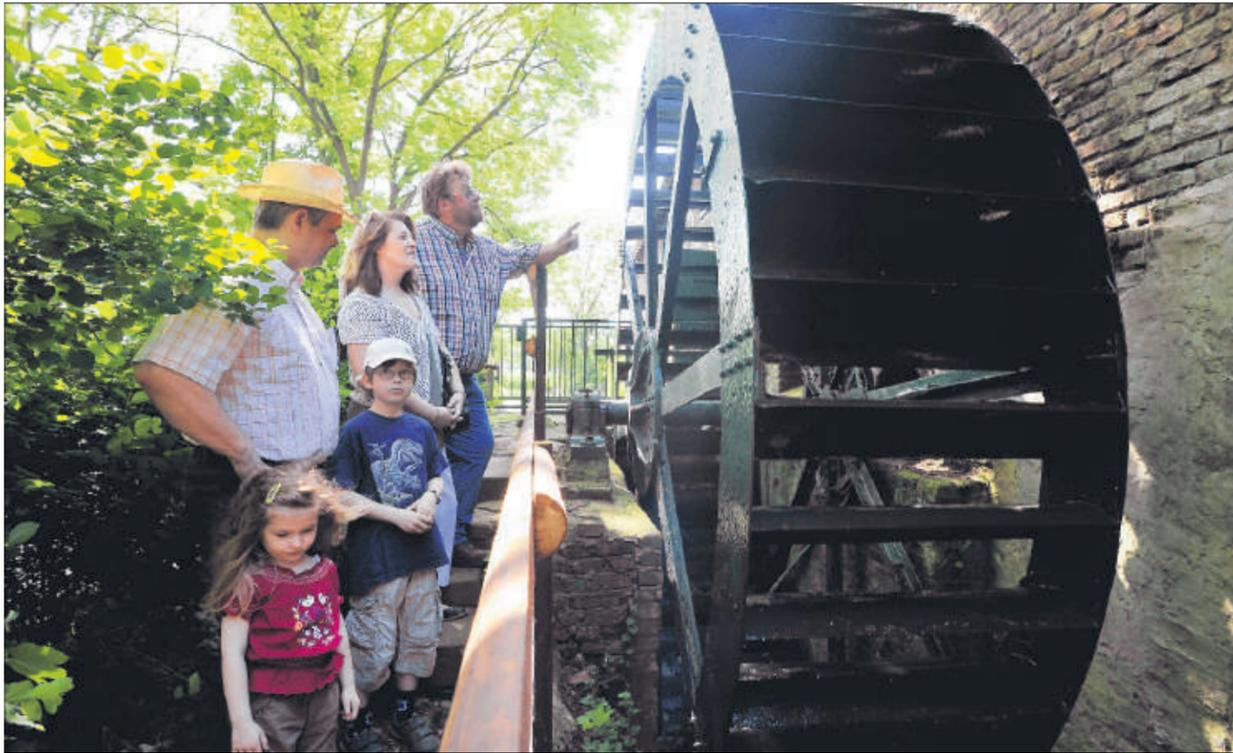
Das Mühlrad der Sindorfer Mühle misst fünf Meter im Durchmesser, die 42 Schaufeln werden gespeist von der Großen Erft. Hausherr Hubert Faßbender (rechts) schätzt die Leistung des Rades auf acht bis zwölf Kilowatt. (Fotos: Tripp)
